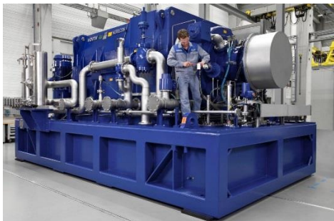
Bild 1: rhenus FU 800 macht die Fertigung des Planetengetriebes Voith Vorecon sicherer. (Quelle: Voith)
