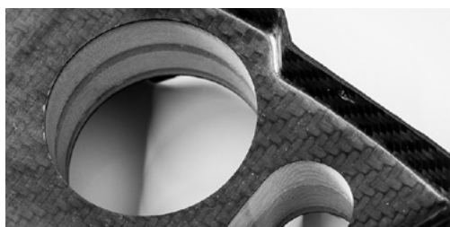
Bearbeitung im Vergleich: trocken (links), mit rhenus Spezial-KSS (rechts)
