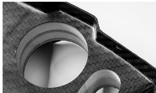
Bearbeitung im Vergleich: trocken (links), mit rhenus Spezial-KSS (rechts)
